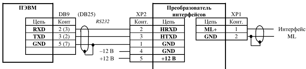
Рисунок 1 – Схема внешних подключений преобразователя при работе с ПЭВМ
