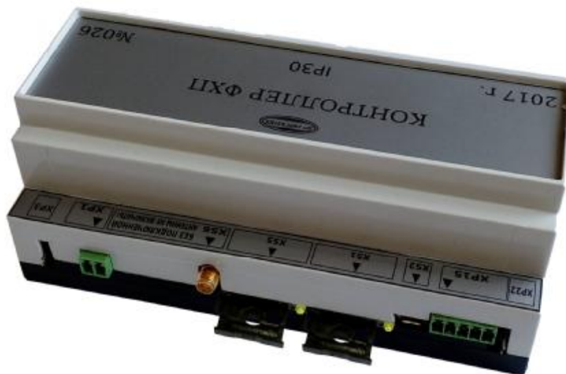
Рис. 3б - Вид контролера ФХП з боку підключення живлення (XP1), антени (XS6) та з'ємних SIM-карт
