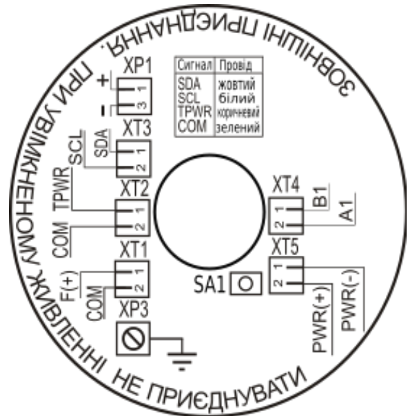
Рисунок 4.4 – Вигляд схеми зовнішніх приєднань ПК-В з живленням від батареї (мікроспоживаючий)
