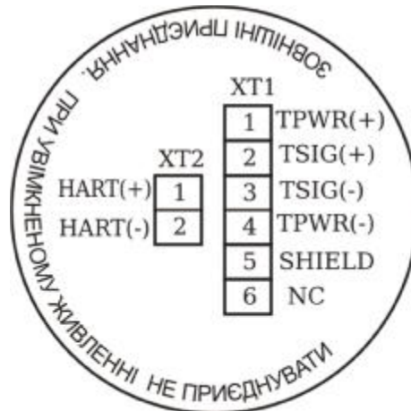
Рис. 2а – Зовнішні приєднання перетворювача тиску ПД-1-ДА(И)
