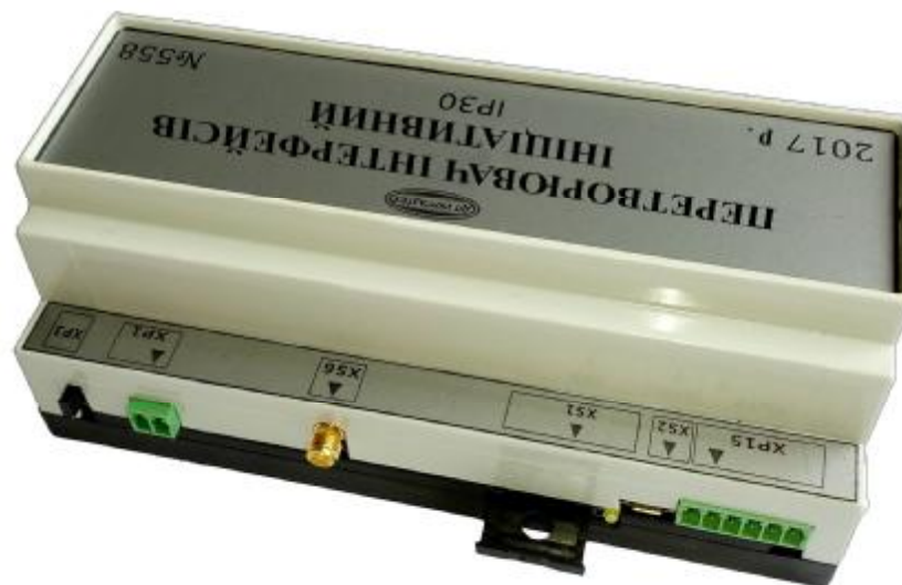
Рис. 3б - Перетворювач інтерфейсів ініціативний з боку підключення живлення (XP1), антени (XS6) та з'ємної SIM-карти
