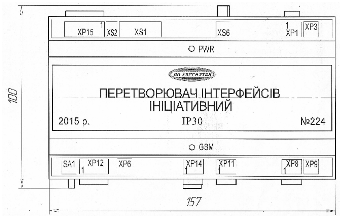
Рис. 2 - Зовнішній вигляд і найменування роз'ємів перетворювача інтерфейсів ініціативного
