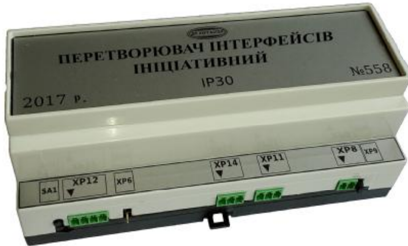
Рис. 3а - Перетворювач інтерфейсів ініціативний з боку основних з'єднань
