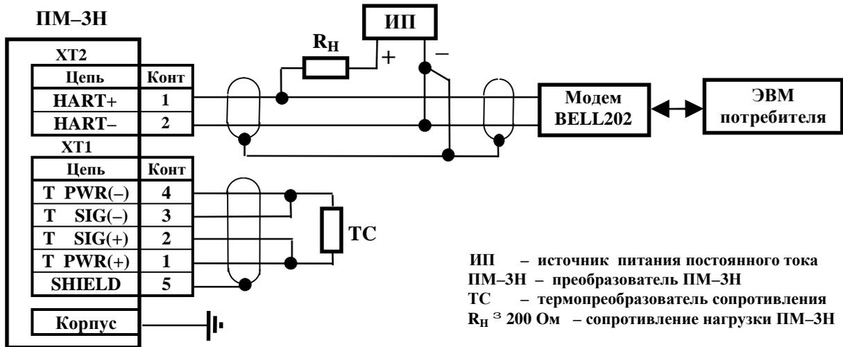
Рисунок 2 – Общая схема внешних подключений преобразователя ПМ-3Н
