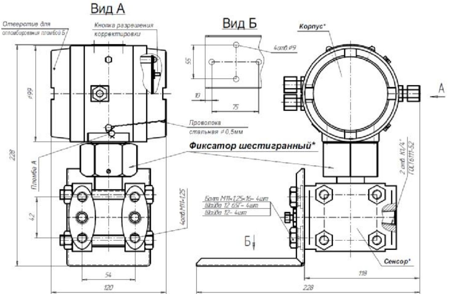
**\*ВНИМАНИЕ.** При монтаже (демонтаже) и эксплуатации крутить фиксатор шестигранный, а также корпус относительно сенсора и сенсор относительно корпуса ЗАПРЕЩАЕТСЯ!
