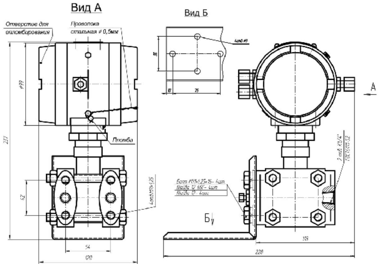
Рисунок Б.2 – Габаритные размеры многопараметрического преобразователя ПМ-3Н, с кронштейном крепления и местом пломбирования.
