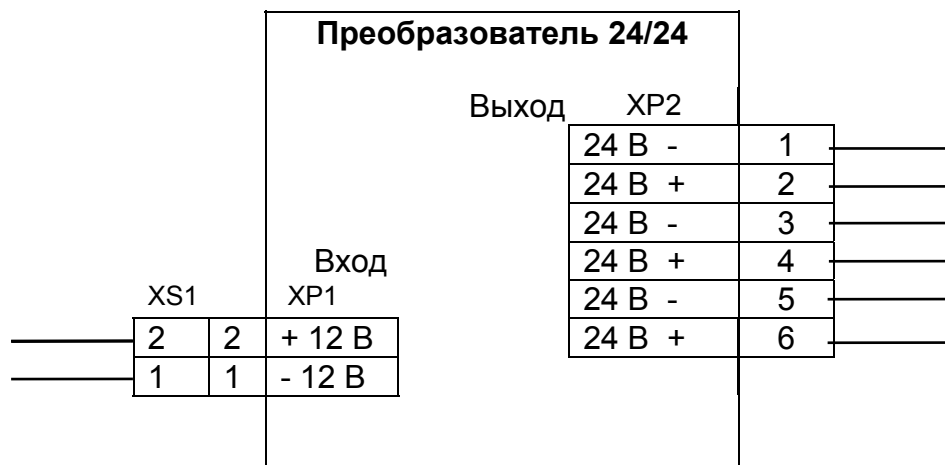
Рис. 1 Схема подключения преобразователя 24/24
